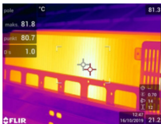
Radiator falownika pracującego w upalny dzień
